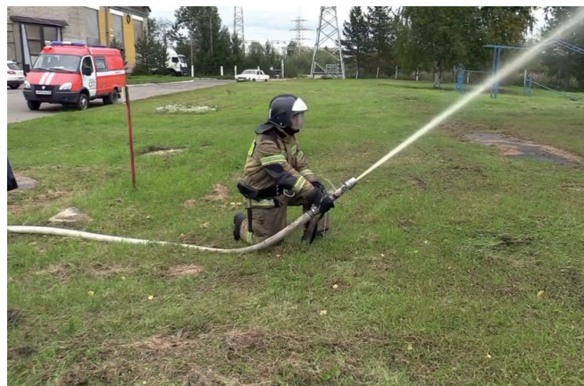
Рис. 6. Проверка ствола пожарного гидранта после ремонта композитом-препегом водяным давлением 6 атм.
