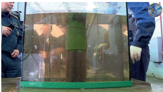
Рис. 2. Заплата из материала для подводного ремонта на металлической трубе
