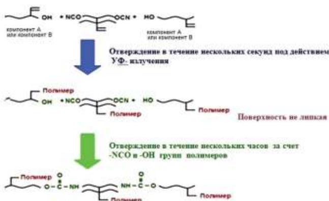
Рис. 2. Схема получения УФ-отверждаемых покрытий
